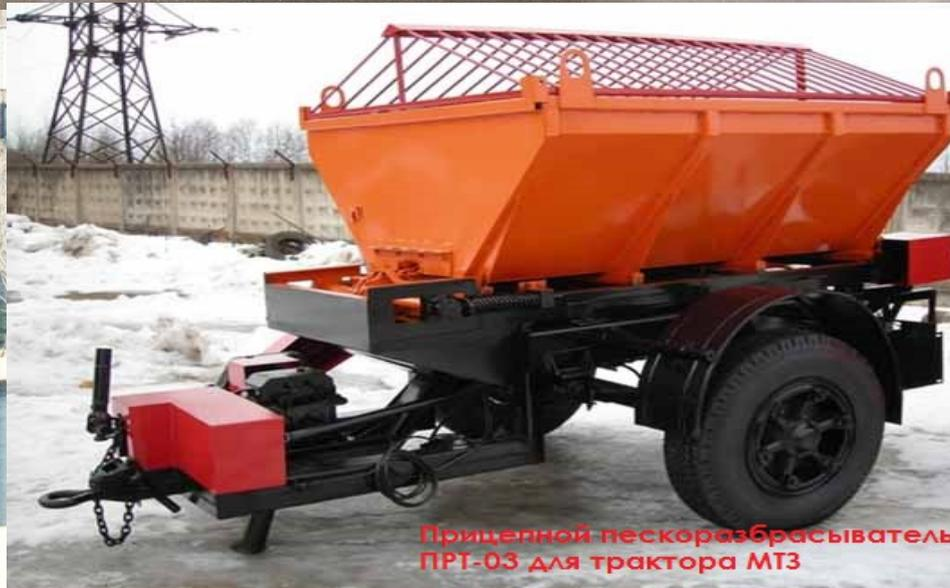
Прицепной пескоразбрасыватель ПРТ-03 для трактора МТЗ
