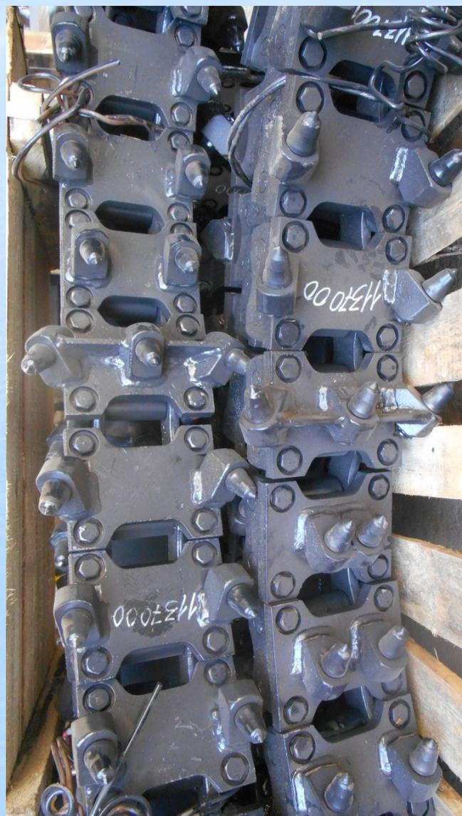
**Применение траншейных резцов:** оснащение рабочих органов экскаваторов траншейных цепных и баровых машин моделей ДЗ-133 (Амкодор), ЭЦ-1800 (Борисовский завод грунторезной техники), ЭТЦ (Дмитровский экскаваторный завод и ОАО "Ирмаш"), ЭЦУ (Дорэлектромаш), баровая грунторезная машина БГ, БГМ и МЗЦ (Земетчинский мех.завод), АТ и АТМ (Копейский машзавод), БР (Михневский РМЗ), Б10М (ЧТЗ-Уралтрак) и др.
